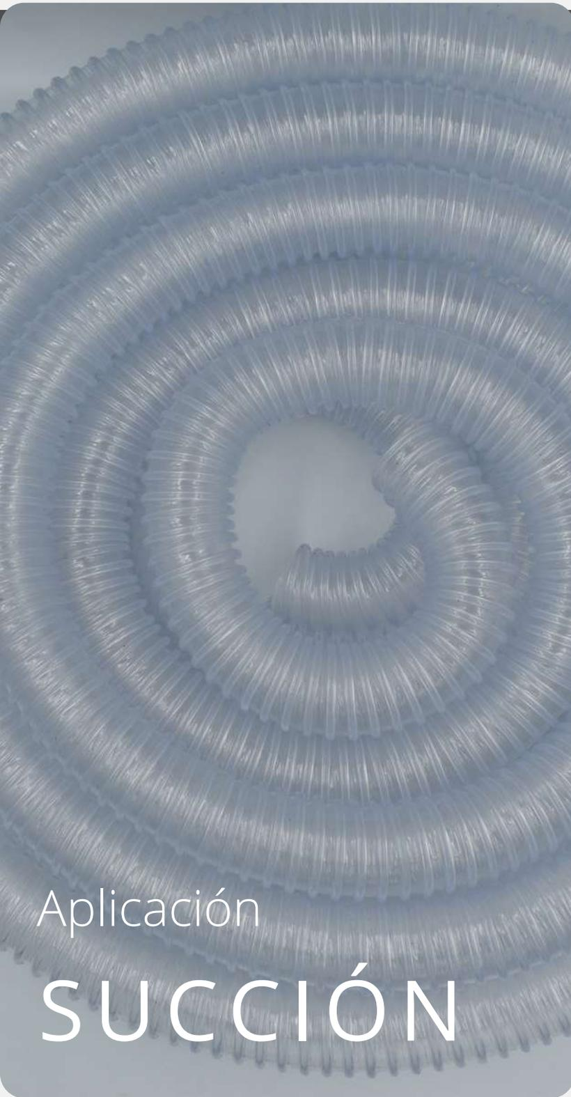
Manguera de PVC muy flexible color cristal transparente, con espiral de PVC rígido que le permite ser doblada sin obstruir su diámetro interior, adecuada para la impulsión y la succión de aire, vapores, polvos, aserrín fino, pelusa, borlas, de gran comodidad en herramientas de corte y sierras para madera, extraordinaria flexibilidad, de fácil almacenaje por ser muy ligera y auto extingible.
